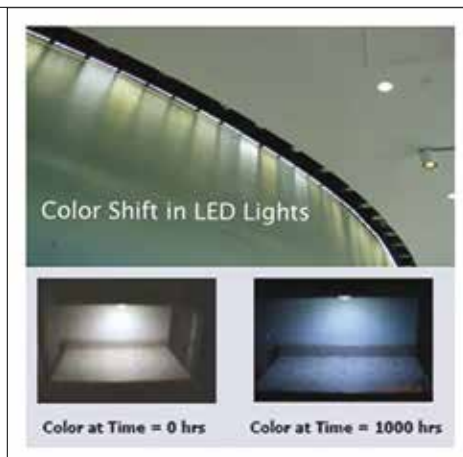
4. Esempio di potenziale Color Shift nella tecnologia LED
